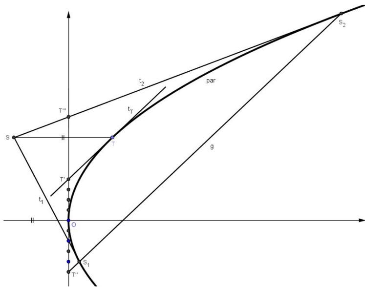
1. **SCHULÜBUNGSBEISPIEL:** In nebenstehender Abbildung wurde die Strecke  $OT'$  in vier gleich lange Teile geteilt und diese Unterteilung über  $O$  hinaus fortgesetzt, woraus  $T'''$  hervor geht. Für den Schnittpunkt  $S$  der Tangenten  $t_1$  und  $t_2$  an par in den Schnittpunkten der Parallelen  $g$  zu  $t_T$  durch  $T'''$  sowie für die Tangente(n)  $t_1$  (und  $t_2$ ) selbst gelten dann die folgenden Sätze:
