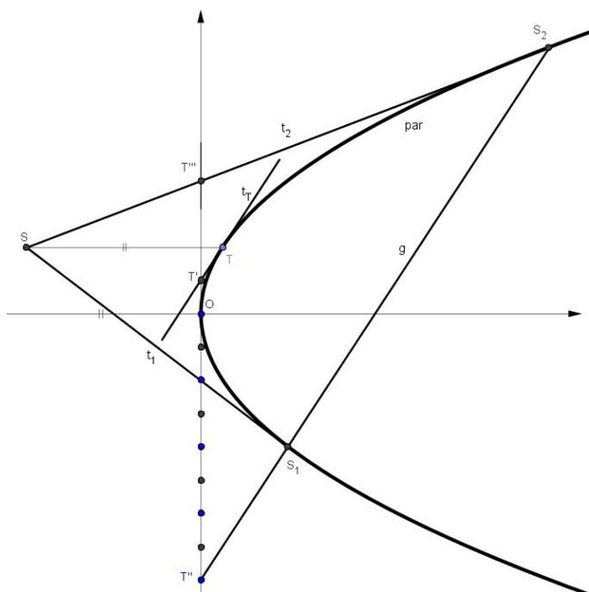
2. **HAUSÜBUNGSBEISPIEL:** In nebenstehender Abbildung wurde der Punkt  $T'$  fortgesetzt am Parabelscheitel  $O$  gespiegelt, was  $T'''$  hervorbringt. Für den Schnittpunkt  $S$  der Tangenten  $t_1$  und  $t_2$  an par in den Schnittpunkten der Parallelen  $g$  zu  $t_T$  durch  $T'''$  sowie für die Tangente(n)  $t_1$  (und  $t_2$ ) selbst gelten dann die folgenden Sätze:
