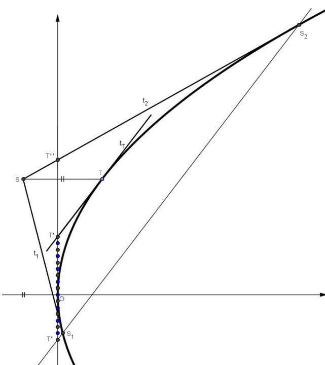
4. **ÜBUNGSBEISPIEL II:** In nebenstehender Abbildung wurde die Strecke  $OT'$  in neun gleich lange Teile unterteilt und diese Unterteilung über  $O$  hinaus fortgesetzt, woraus  $T''$  hervorgeht. Für den Schnittpunkt  $S$  der Tangenten  $t_1$  und  $t_2$  an par in den Schnittpunkten der Parallelen  $g$  zu  $t_T$  durch  $T''$  sowie für die Tangente(n)  $t_1$  (und  $t_2$ ) selbst gelten dann die folgenden Sätze:
