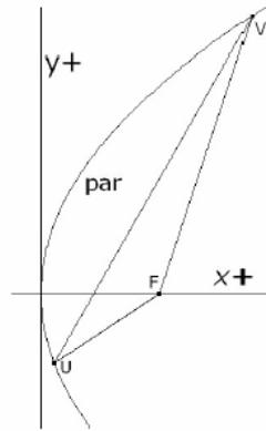
Für den Flächeninhalt  $\mu$  des in obiger Figur abgebildeten Dreiecks  $\Delta UFV$  gilt ausgehend von par [par:  $y^2 = 2px$ ] die Formel  $\mu = \frac{1}{4p} \cdot |y_U - y_V| \cdot (y_U y_V + p^2)$ . Verifiziere dies für jene Parabel in erster Hauptlage, welche von  $t : 3x - 4y + 96 = 0$  berührt wird, und zwar für den entsprechenden Berührungspunkt  $V$  sowie  $U(x_U | -12)$ !
